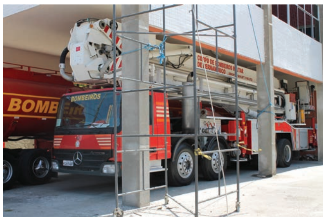
Plataforma Autobomba Tanque, com alcance de 11 metros
