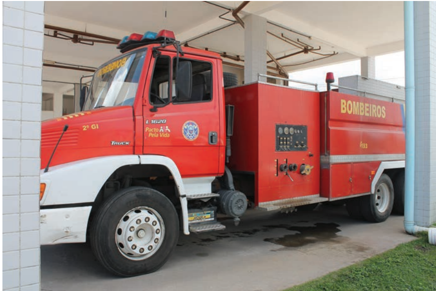
Autobomba tanque da seção de Suape é antiga e apresenta vazamento no reservatório
