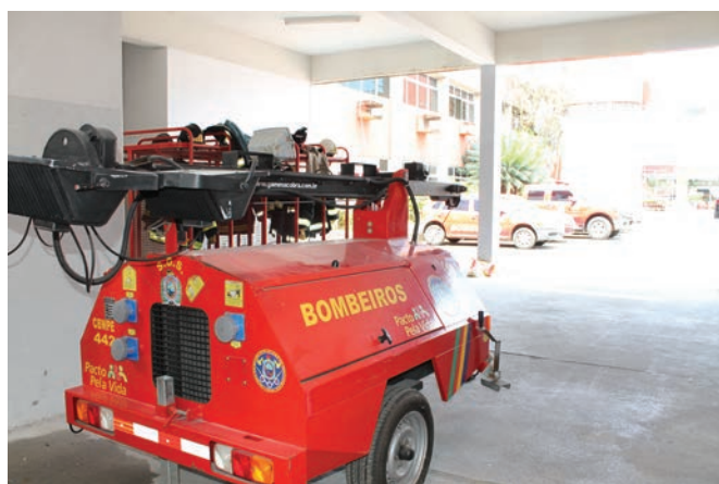
Torre de iluminação com reboque
