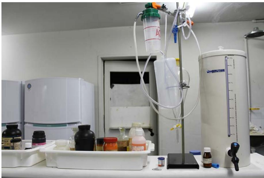
*Imagem 275: Bandejas utilizadas como item de segurança para minimizar as consequências de um possível acidente com soluções no laboratório. Um paliativo simples e barato.*
