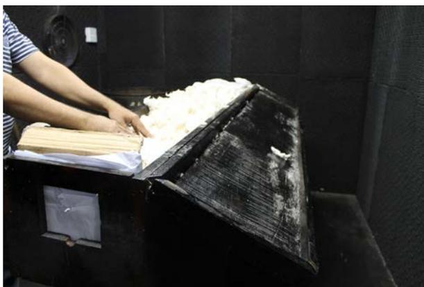
*Imagem 213: Aspecto da sala de disparos, com barril (ao fundo) e câmara feita de madeira e preenchida com estopa para recolhimento dos projéteis.*
