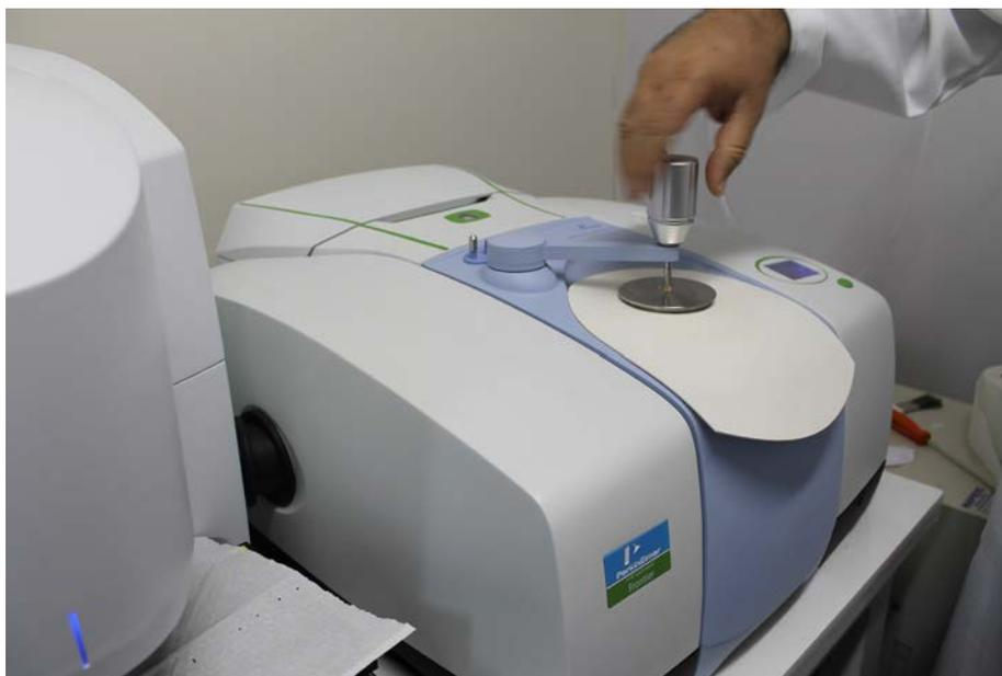
Imagem 267: Perito insere amostra para análise do espectrofotômetro.
