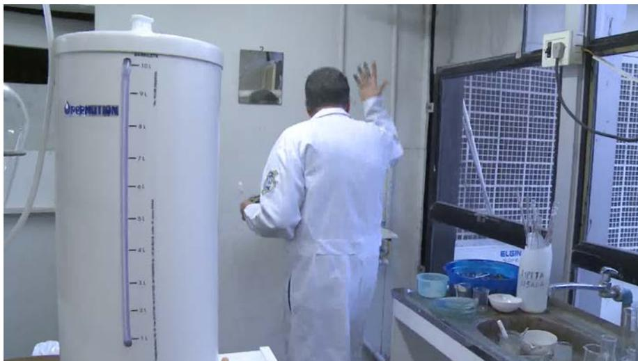
*Imagem 278: Lavador de emergência oferece riscos maiores em caso de acidente devido à existência de um degrau e proximidade com as janelas.*
