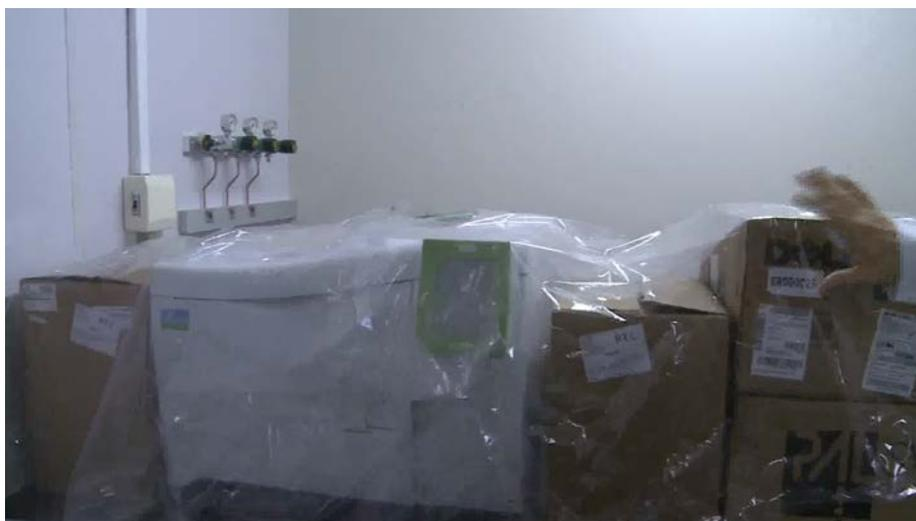
*Imagem 270: Novo cromatógrafo gasoso adquirido pelo IC. O Instituto aguardava a finalização da instalação de um sistema de fornecimento de gás pela empresa vencedora da licitação de aquisição do serviço para o funcionamento do aparelho. Na parede, pode-se observar parte das instalações já realizadas.*
