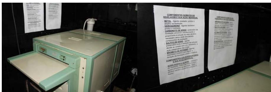
Imagem 345: A máquina de revelação de radiografias. À direita, avisos colados nas paredes com informações sobre as substâncias manipuladas nos procedimentos de revelação.
