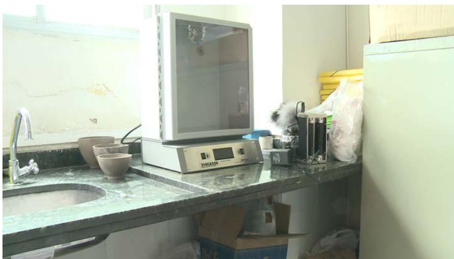
*Imagem 72: Equipamentos utilizados para as perícias. Nesta imagem, uma câmara vertical de fumigação por aquecimento de substâncias e luzes para revelação de impressões. À esquerda, vê-se um arquivo e uma pilha de pastas, contendo documentos em um espaço sobre a bancada.*
