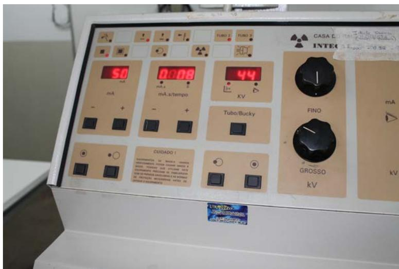
Imagem 341: Painel do aparelho de Raio-X.
