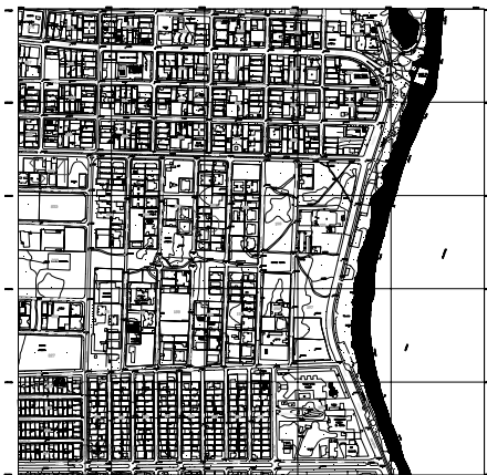
Figura 11 – Folha UTM na escala de 1:2.000: produto cartográfico digital georreferenciado, oriundo da restituição aerofotogramétrica digital, específico para o cadastro imobiliário municipal.
