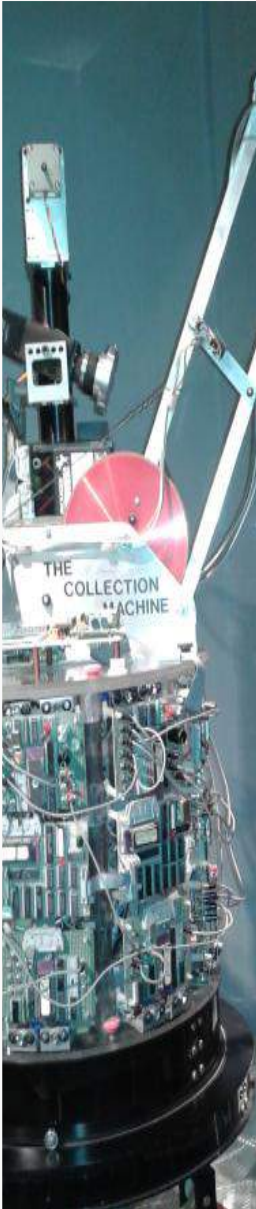
Equipamento desenvolvido para coleta de latas de alumínio (Museu do MIT, Boston).
